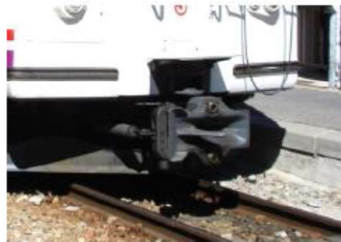
Figura. 5-28 Enganche mecánico con acoplamiento neumático
