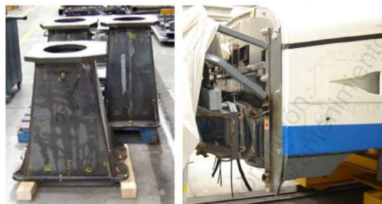
Figura. 5-35 Sistema de absorción de impactos en estructura
