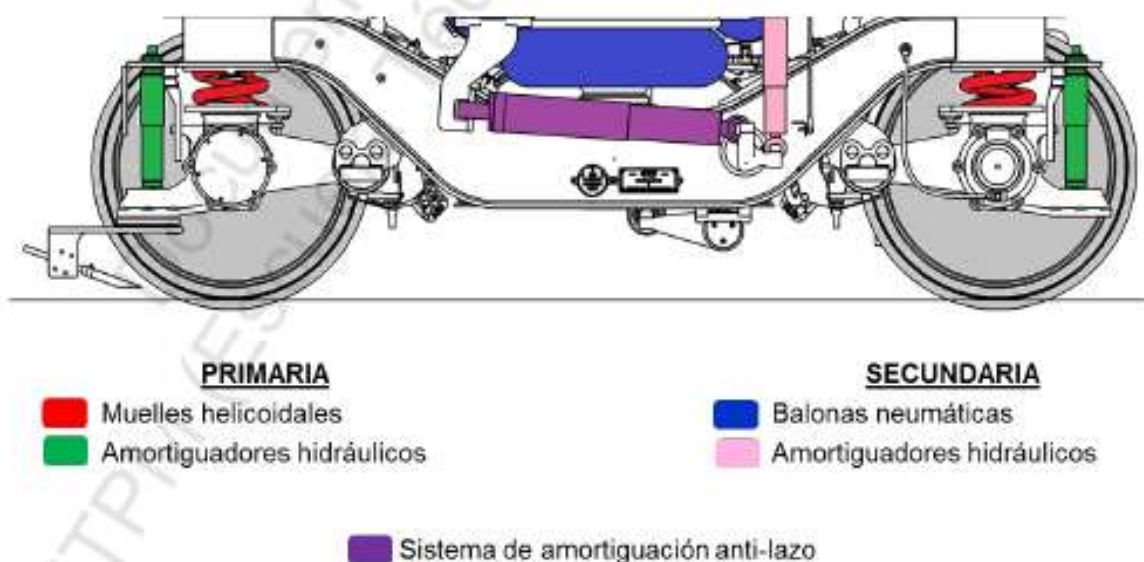
Figura. 2-55 Suspensión por balonas neumáticas
