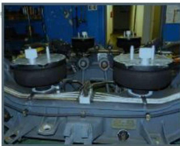
Figura. 2-55 Suspensión por balonas neumáticas
