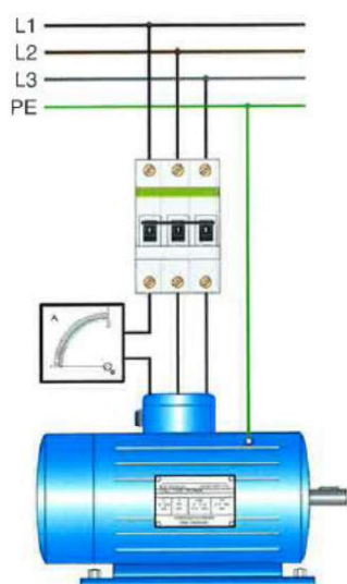
↑ Figura 4.33. Conexión del amperímetro en una de las fases.
