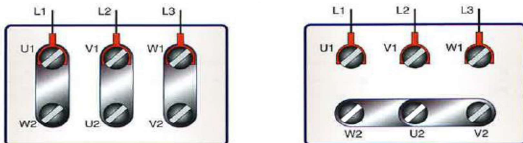
↑ Figura 4.16. Conexión triángulo y conexión estrella.
